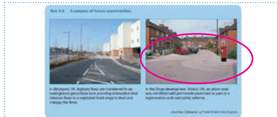
Figuur 56 Voorbeeld waterdoorlatende verharding en herinrichting weg (Bron: Ciria, 2012)
